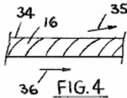
**Fig.4** montre un détail des lances premier - fluides où **34** sont mur sur que les lances **16** sont montées, **35** sont la direction approximative de partir du premier - fluide, et **36** indiquent direction de rotation de premier rotor.
