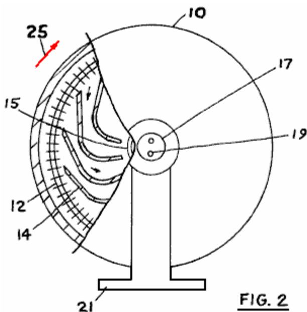
**Fig.2** est une vue de la fin de l'unité montrée dans **Fig.1**. Où **10** sont le rotor, **17** l'arbre, **19** sont un passage du caloporteur, **21** sont la base, **14** sont girouettes placées afin qu'ils inclinent loin de la direction de rotation comme indiqué par flèche **25**, en passant l'inwards fluide actif simultanément, **12** sont l'échangeur de la chaleur chauffant, et **15** sont l'échangeur de la chaleur refroidissant.
