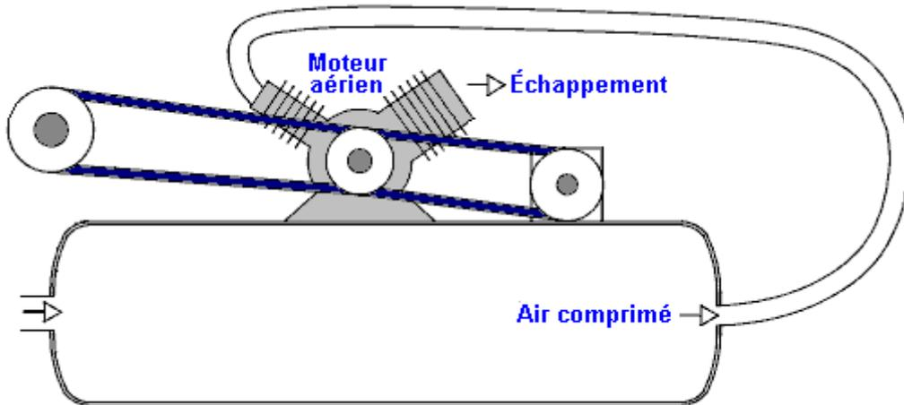
En premier, vous avez un moteur de l'air ordinaire, fourni avec l'air comprimé d'un réservoir de la pression. Ce moteur épuise son (froid, allongé) air à l'atmosphère. Le moteur propulse deux compresseurs qui entre eux gardent le réservoir plein d'air comprimé.
