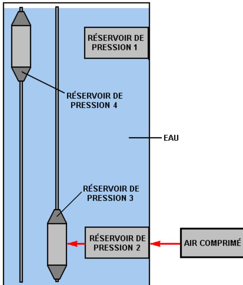
Il y a un récipient grand, vertical rempli de l'eau. Il contient quatre réservoirs de haute pression; les réservoirs 1 et 2 sont fixés dans la position pendant que les réservoirs 3 et 4 sont montés sur un système de guidage qui leur permet de bouger en haut et en bas verticalement, avec leur mouvement en conduisant le générateur de production.
