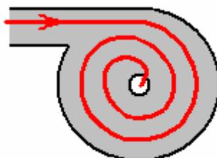
Il y a un gain d'énergie dans un tourbillon, comme peut être vu dans un ouragan ou tornade, mais la chose vraiment intéressante ici est le changement dramatique dans température causée par le changement dans pression comme l'air étend. La proportion de gain de la chaleur chauffer la perte est contrôlée par la proportion des dimensions des ouvertures qui sont pourquoi il y a une lance réglable sur la petite ouverture.
