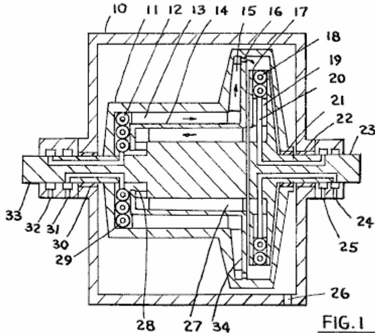
**Fig.1** montre une section en colère d'une forme de la turbine. Dans cette forme, le premier fluide est scellé dans le rotor avec un deuxième fluide qui fournit la chaleur au premier fluide, et un troisième fluide qui refroidit le premier fluide, être circulé de sources externes.
