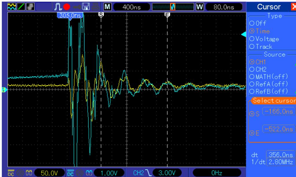
Die gelbe Linie zeigt die Rückkopplung zur Batterie an. Der Prototyp nutzt eine PVM12 Stromversorgung von <http://www.amazing1.com/> die beabsichtigt ist, eine Plasmakugel zu fahren.
