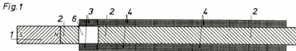
Die lineare Energiegenerator im Querschnitt in 1 gezeigt, besteht aus einem Permanentmagnetstab 1 mit einem Weicheisen-Magnetgenerator Kern 2, der aus einem einzigen Stück sein können, oder, wie hier gezeigt, in zwei Abschnitte unterteilt. Die magnetische Flussänderungsspule nicht direkt auf den Permanentmagneten 1 angebracht, so daß der Permanentmagnet 1 ist nicht auf die durch den Magnetfluss Modifikation Spule 3 erzeugten Wechselfeldern ausgesetzt.
