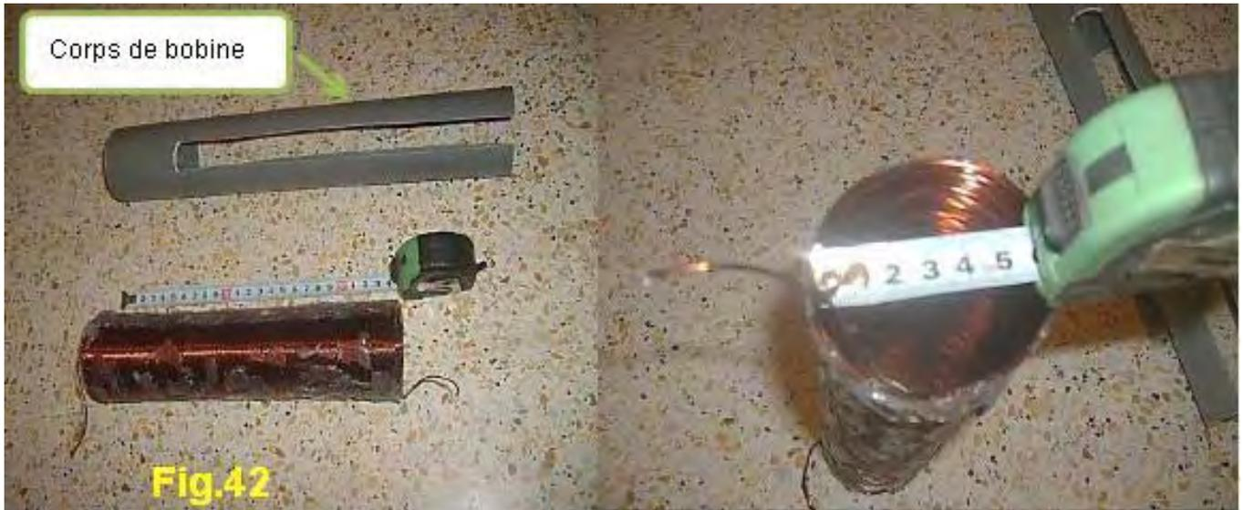
La longueur de la bobine est d'environ 25 cm, comme illustré sur la Fig.42, le diamètre est de 6 cm, et l'épaisseur du fil est de 1,18 mm (AWG # 17 ou 18 SWG) et le nombre de tours est d'environ 200 Fig.43 montre un certain agréable étincelles de bobine L2 :
