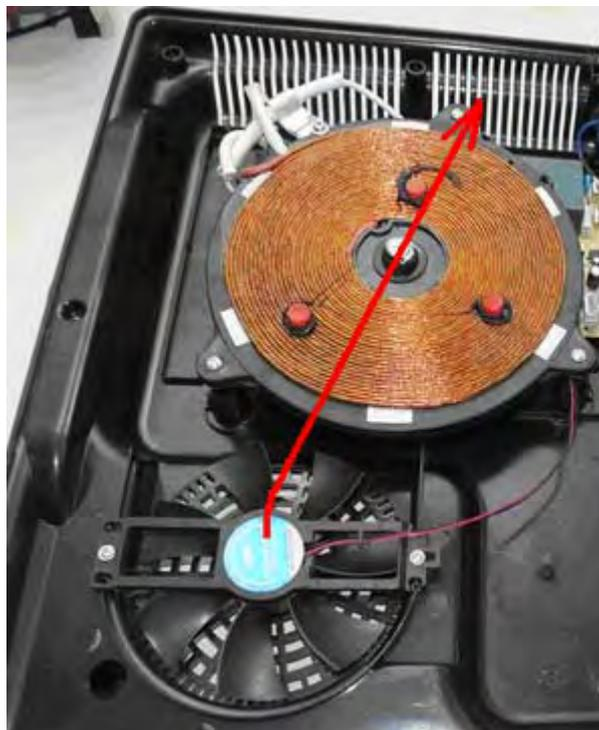
La bobine brune devient chaude, et donc il ya des entretoises sur lui pour empêcher la forme de l'enveloppe extérieure cool ramasser la chaleur de la bobine. Il y a également un ventilateur qui aspire l'air dans des dessous de l'affaire et il souffle sur la bobine afin de garder la chaleur vers le bas.
