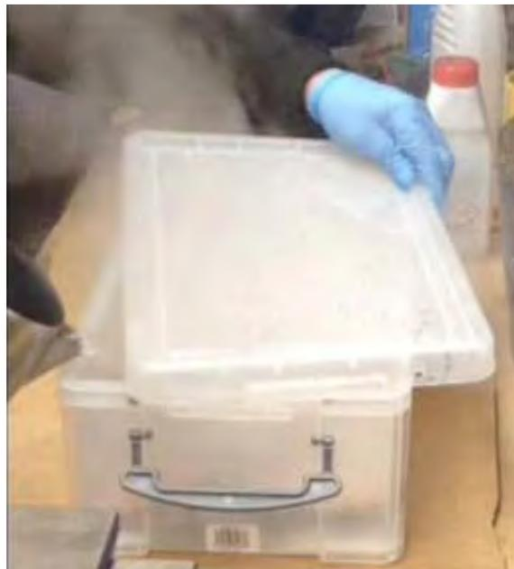
Se viene trattata una piastra di rame, allora entrambe le parti devono essere in contatto con la soluzione di sodio caustico, per ottenere che una bassa tavola di maglia metallica sia utilizzata per trattenere la parte inferiore della piastra di rame dalla base della scatola di trattamento. Al termine dell'elaborazione, la lastra di rame sarà nera su tutte le facce.
