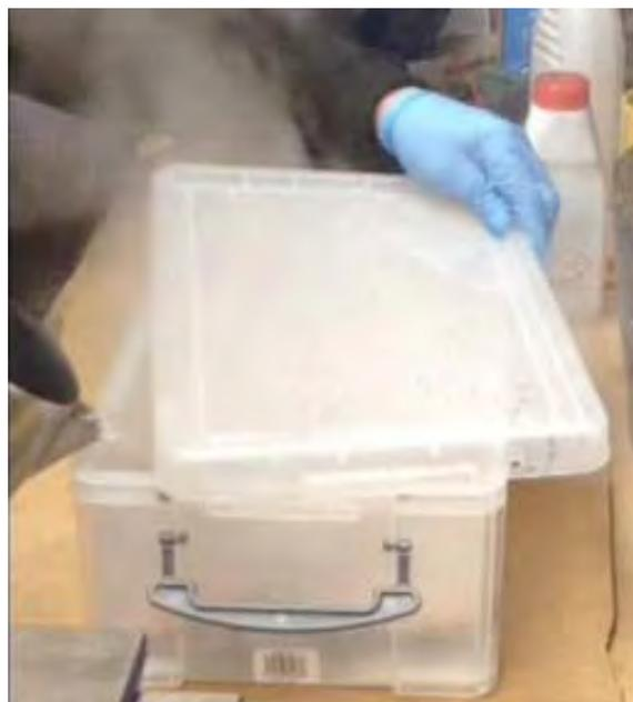
Si une plaque de cuivre est en cours de traitement, les deux côtés doivent être en contact avec la solution de soude caustique, de manière à obtenir qu'une faible table de treillis métallique est utilisée
