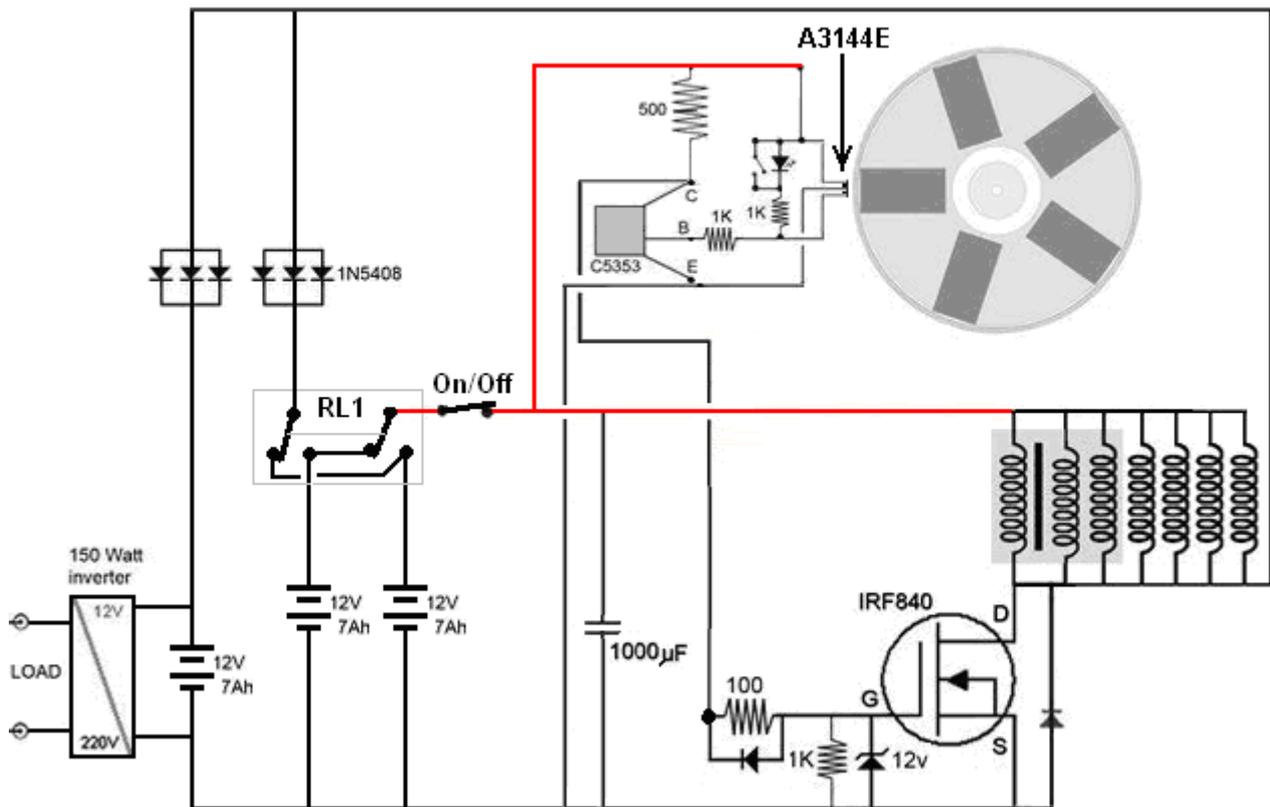
Questo circuito ha un'uscita continua da 150 watt e utilizza tre batterie da 12 volt. Vengono utilizzate le prime due batterie, una per alimentare il circuito mentre la seconda viene ricaricata attraverso tre diodi cablati in parallelo per migliorare il flusso di corrente di ricarica. L'interruttore a due vie di commutazione a due vie "RL1" scambia le batterie ogni pochi minuti utilizzando il circuito mostrato di seguito. Questa tecnica mantiene entrambe le batterie completamente cariche.
