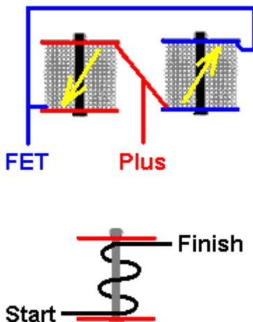
I due gruppi di cinque bobine in serie sono collegati in direzioni opposte come mostrato sopra. L'inizio del set di bobine mostrate in blu e il finale del set di bobine mostrate in rosso sono collegate al Plus della batteria. Ciò fa sì
