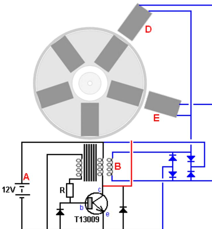
Bobine "B", "D" ed "E" sono tutti attivati allo stesso tempo da tre diversi magneti. L'energia elettrica prodotta in tutte e tre le bobine è passato ai quattro diodi blu per produrre un rifornimento di corrente continua che viene utilizzato per caricare la batteria "A" che alimenta il circuito. Tale ingresso supplementare per la batteria e
