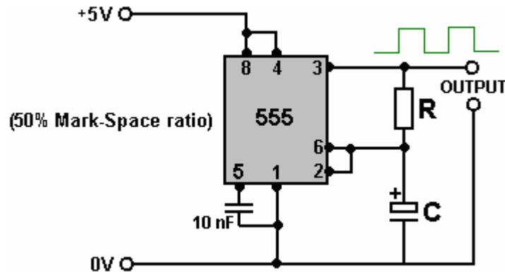
Il condensatore utilizzato deve essere di alta qualità con perdite molto basse al fine di ottenere questa forma d'onda attivata per esattamente lo stesso tempo in cui è disattivata. Questo è importante se vogliamo che le due batterie ricevano lo stesso tempo che alimenta il carico quando il tempo che ricevono viene ricaricato.
