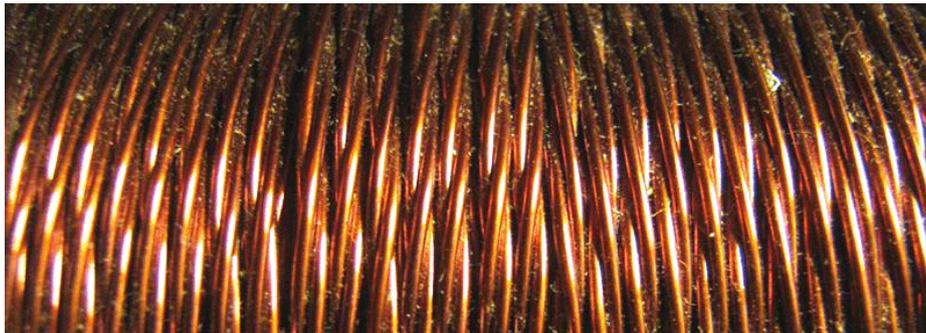
Questa bobina completato ora contiene tre bobine separate in stretta vicinanza l'uno all'altro e che disposizione è eccellente quando una bobina viene acceso, per indurre l'energia nelle altre due bobine. Questo avvolgimento ora contiene bobine 1,2 e 3 dello schema elettrico. Non c'è bisogno di preoccuparsi con la marcatura le estremità di ogni filone di filo come un semplice ohmmetro vi dirà che due estremità hanno un avvolgimento tra di loro.
