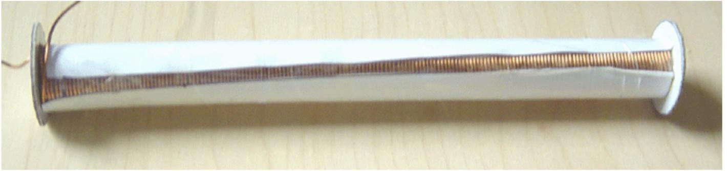
Questo processo viene ripetuto fino a quando tutti i livelli desiderati sono stati feriti. Infine, il filo viene tagliato con pochi pollici a sinistra per il collegamento della bobina nel circuito e il filo viene fatto passare attraverso un secondo foro in una delle flange:
