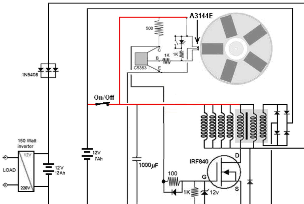
Qui, la batteria che alimenta l'inverter che alimenta il carico è aumentata di capacità e mentre lo sviluppatore ha utilizzato due delle sue batterie da 7 Ahr, è possibile utilizzare una batteria standard da 12 volt da 12 Ahr per uno scooter elettrico. Tutte le bobine tranne una sono utilizzate per fornire corrente alla batteria di uscita e l'altra bobina, che fa parte della bobina principale a tre fili, viene utilizzata per alimentare direttamente la batteria.
