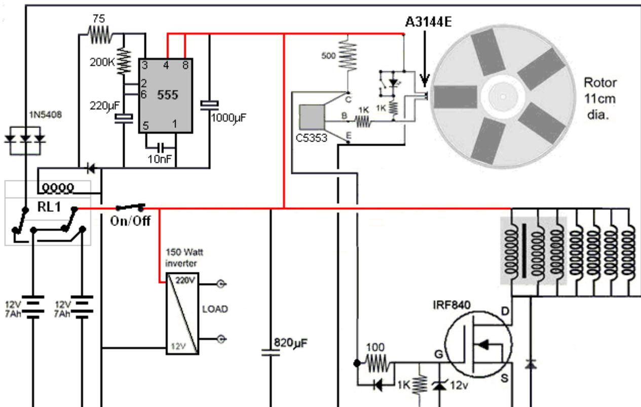
In questa versione del circuito, viene utilizzato un relè senza ritenuta da 12 volt. Il relè normalmente disegna 100 milliampere a 12 volt, ma una resistenza da 75 ohm o da 100 ohm in serie riduce quella corrente a circa 60 milliampere. Quella corrente viene disegnata solo per metà del tempo in quanto il relè non viene acceso quando vengono utilizzati i contatti "normalmente chiusi". Il sistema si auto-alimenta molto in modo soddisfacente come prima.
