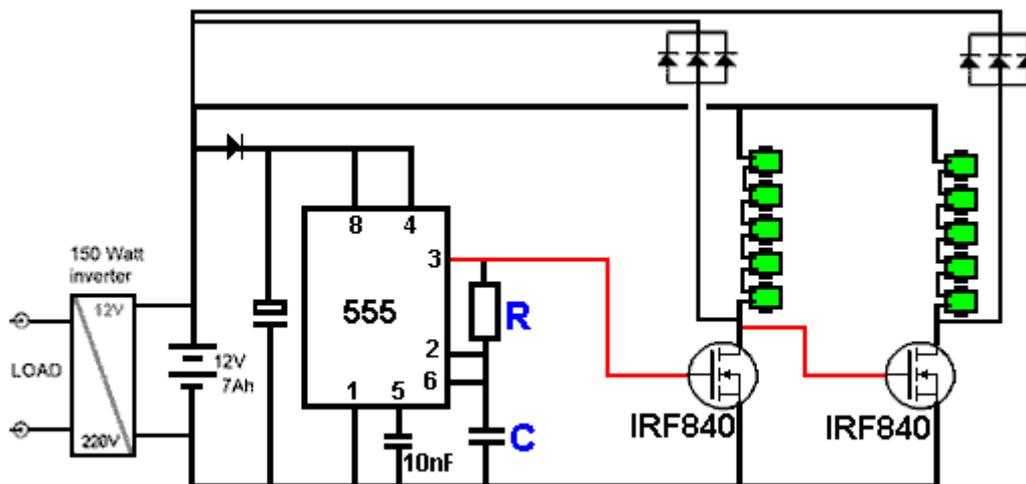
Quindi, quando il primo transistor si accende, il secondo transistor si spegne e viceversa. Ciò restituisce il doppio degli impulsi al secondo alla batteria di azionamento senza aumentare la frequenza di pulsazione di una delle catene della bobina. Ricorda inoltre che i transistor sono abbastanza potenti da pilotare diverse catene di bobine simultaneamente, e che ogni bobina aggiuntiva può aumentare la potenza in uscita disponibile.
