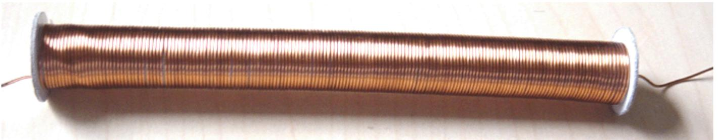
Questo generatore può essere costruito in migliaia di varianti, la principale differenza sono le bobine utilizzate: il materiale del nucleo, la lunghezza del nucleo, il diametro del filo e il numero di strati avvolti. Puoi, ovviamente, iniziare con una bobina e vedere come si comporta il tuo circuito, e in seguito aggiungere uno o più bobine per aumentare le prestazioni.
