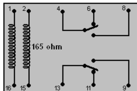
Questa è la versione elettronica di un interruttore meccanico bipolare. Un breve impulso di corrente tra i pin 1 e 16 blocca l'interruttore in una posizione e, successivamente, un impulso di corrente tra i pin 2 e 15 lo blocca nell'altra posizione. Lo scarico corrente sul circuito sarebbe quasi zero.
