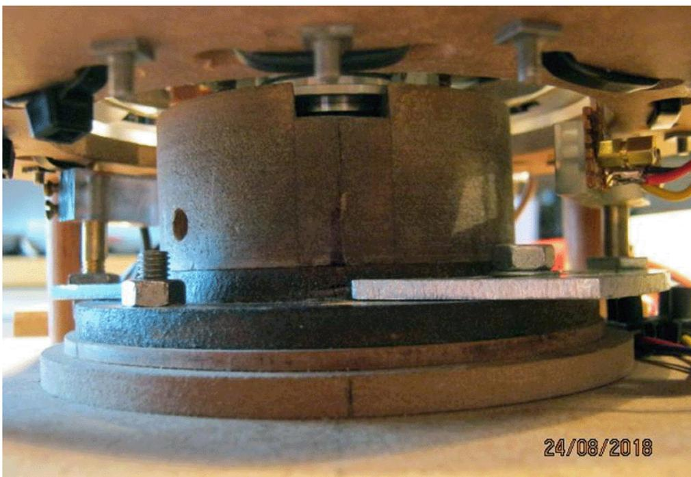
È importante capire che mentre il rotore del diametro di 110 mm ha cinque magneti situati a intervalli regolari attorno alla sua circonferenza, ora ci sono dieci bobine sullo statore circostante e ora ci sono dieci impulsi per giro. Questi impulsi sono potenti e quando la corrente viene interrotta, ogni catena di cinque bobine genera picchi di 600 volt (anche se in certe occasioni può raggiungere 900 volt).
