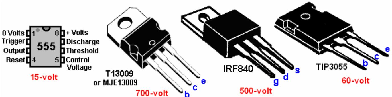
Se si decide di utilizzare un ingresso a 24 volt, si ricorda che sia il chip 555 che il chip 4017 devono essere mantenuti a 12 volt in quanto non sono in grado di gestire 24 volt. Inoltre, se si decide di farlo, è necessario un inverter a 24 volt.
