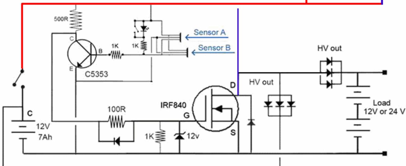
Se vogliamo riprodurre questa performance senza il rotore e i suoi magneti, allora dobbiamo applicare impulsi da 12 volt a queste due catene di bobine 417 volte al secondo. Potrebbe sembrare difficile se non si ha dimestichezza con l'elettronica, ma in realtà è un compito molto semplice e 417 Hz è un'operazione molto lenta per un circuito elettronico poiché potrebbero facilmente generare 3.000.000 di impulsi al secondo.
