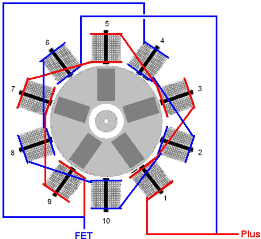
Tutte e dieci le bobine sono pulsate nello stesso istante e quell'istante è disposto ad accadere quando un magnete del rotore si trova tra le due bobine opposte. Una bobina spinge via il magnete e l'altra bobina tira lo stesso magnete verso se stesso. Questo è molto efficace con il rotore del rotore così veloce che lo sviluppatore lo descrive come "spaventoso" e deve bloccarlo sul banco di lavoro a causa della potenza generata.
