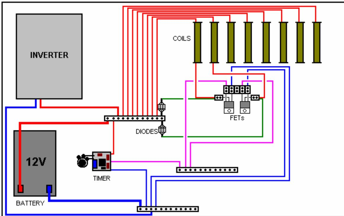
Questa disposizione riduce al minimo la saldatura e consente facili alterazioni in quanto il circuito viene esteso per una maggiore potenza di uscita. La scheda timer può essere sostituita in seguito se si decide di utilizzare uno stile di operazione Dividi per N.
