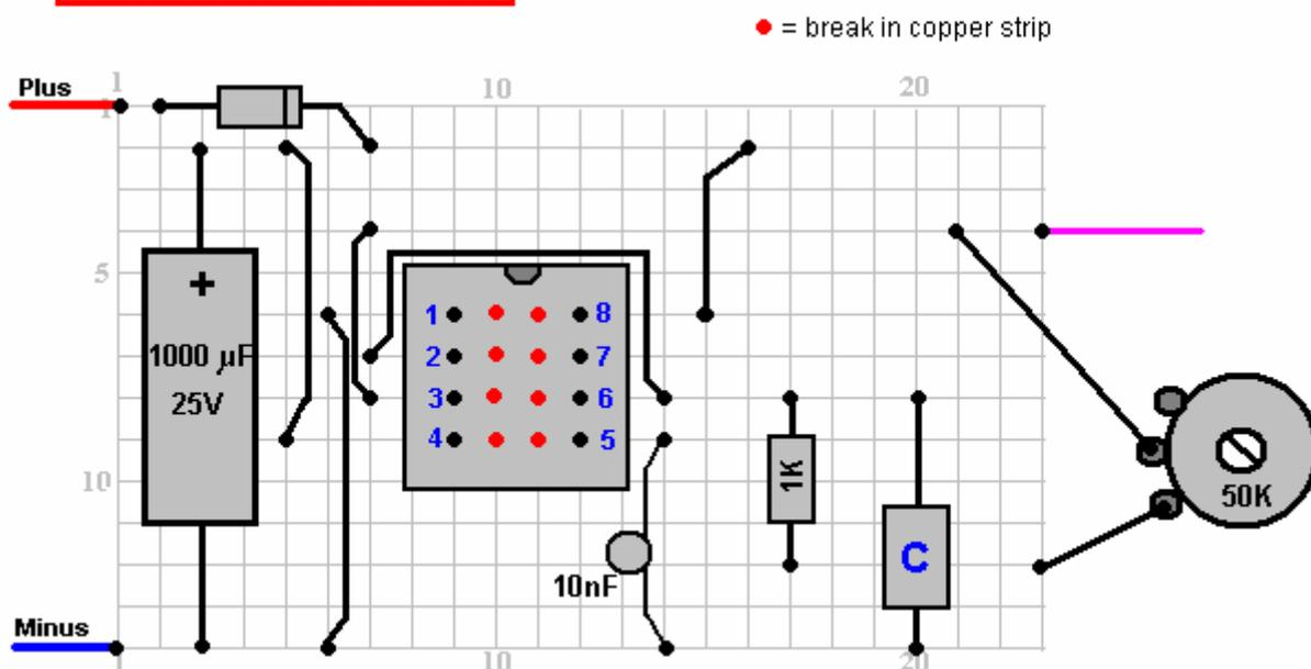
Il condensatore "C" sarà di circa 10 nF e il resistore variabile può essere 47K o 50K lineare o potrebbe essere utilizzato un valore più alto.
