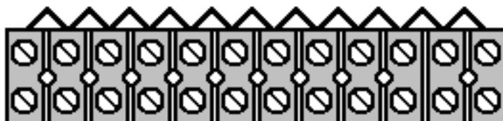
Abbiamo un problema con il collegamento dei transistor FET perché i loro piedini sono così vicini che non si inseriscono comodamente in un blocco connettore a vite. Possiamo aggirare questo problema tagliando un connettore dal blocco, piegando il perno centrale del FET verso l'alto in una posizione verticale e usando il connettore single-cut-off per effettuare la connessione al pin centrale del FET:
