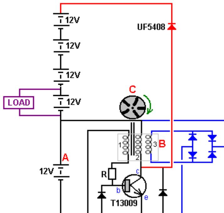
La batteria ha segnato poteri "A" del circuito. Un rotore "C", contenente cinque magneti viene spostato in modo che uno dei magneti passa vicino alle bobine. Le bobine impostare "B" ha tre bobine appositamente ferita e il magnete mobile oltre quei tre bobine genera una piccola corrente di numero bobina "1" che poi fluisce attraverso la resistenza "R" e nella base del transistor, facendolo accendere. La potenza che fluisce attraverso la bobina
