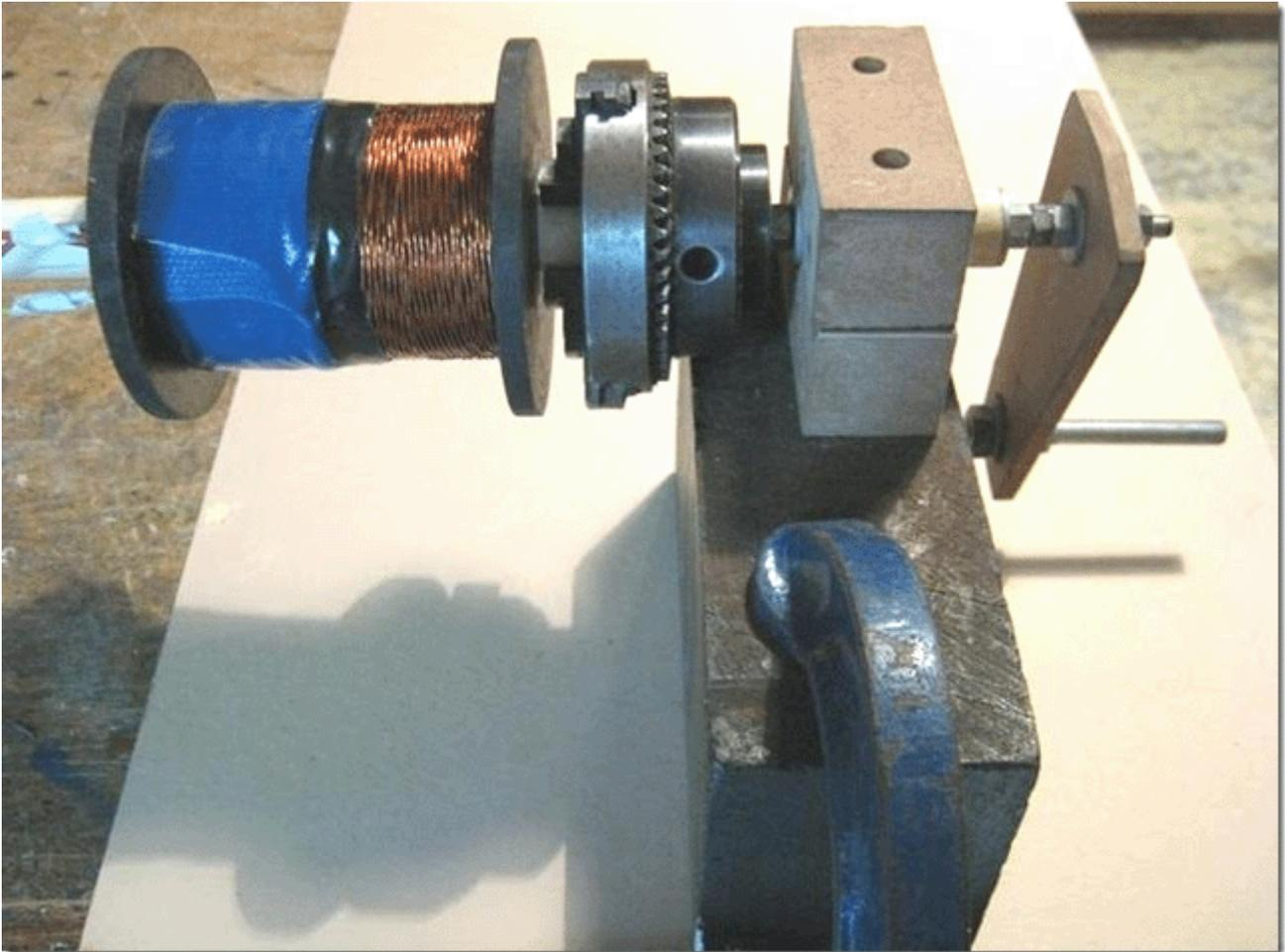
I tre filoni di filo che le bobine di forma "1", "2" e "3" sono filo di diametro 0,7 millimetri e sono intrecciati insieme per diventare un filo "Litz", prima di essere avvolto nella bobina "B". Ciò produce una molto più spessa filamento filo composito che è facile da avvolgere accuratamente sulla bobina. L'avvolgitore mostrato sopra utilizza un mandrino per afferrare il nucleo della bobina per l'avvolgimento, ma qualsiasi semplice avvolgitore funzionerà bene.
