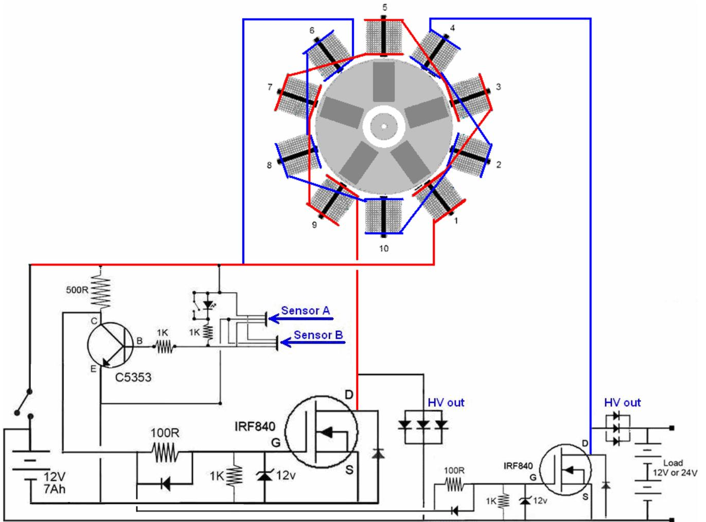
Allo stato attuale, questo circuito può caricare batterie da 12 V o 24 V o alimentare un inverter da 12 V collegato tramite una batteria da 12 V o un inverter da 24 V collegato attraverso una batteria da 24 V. Una versione di questo circuito con meno componenti che funziona davvero molto bene è questa:
