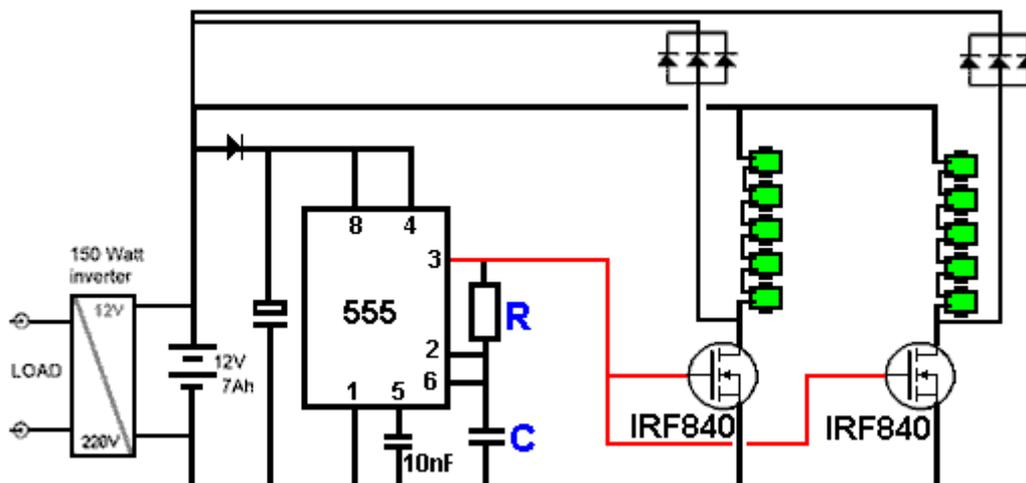
Il resistore "R" e il condensatore "C" controllano la frequenza dell'impulso e il risultato è molto buono. Tuttavia, poiché lo sviluppatore ha alimentato entrambe le catene di bobine del suo circuito rotore da un singolo transistor (anche se generano almeno impulsi di retroazione da 600 V), ha usato un solo transistor per i suoi test. Gli piace anche usare il suo circuito che scambia due batterie, una per fornire corrente mentre l'altra si ricarica, ma questa è una cosa da poco.
