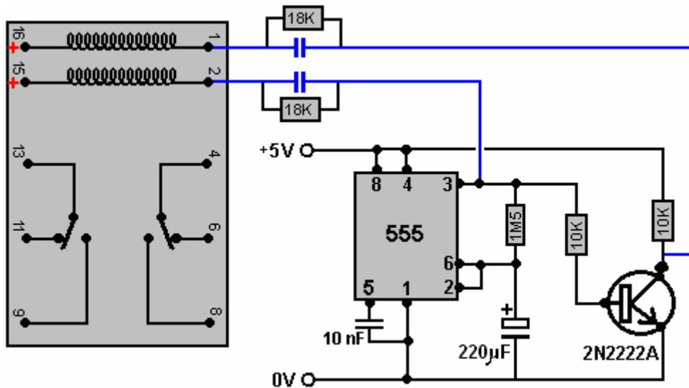
I condensatori mostrati in blu sono scelti per operare il relè fisico reale che viene utilizzato nel circuito. Forniscono al relè un breve impulso di commutazione ogni cinque minuti circa. Le resistenze da 18 K attraverso i condensatori devono scaricare la carica del condensatore durante i cinque minuti in cui il timer si trova nello stato alternativo.
