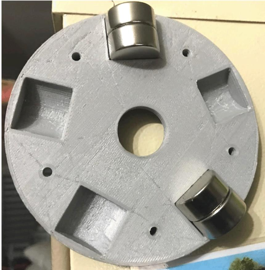
Ce rotor imprimé en 3D est fabriqué en deux moitiés qui sont ensuite boulonnées ensemble.
