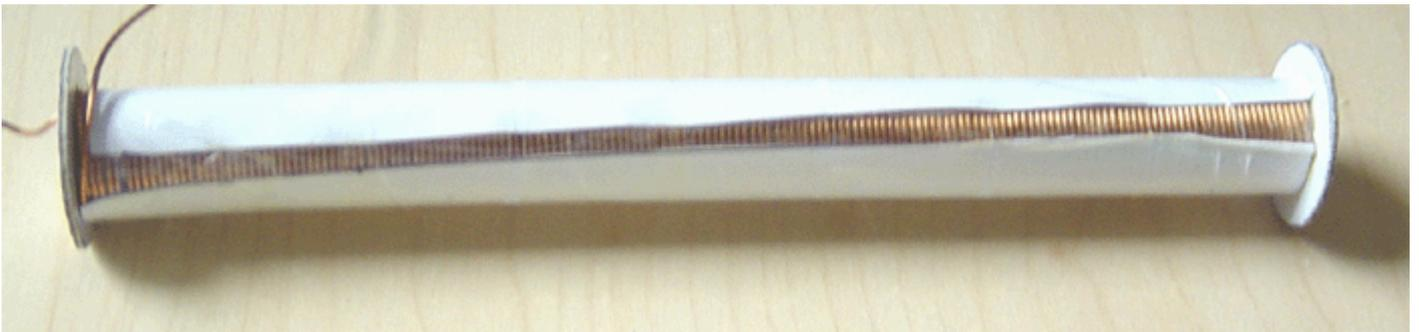
Ce processus est répété jusqu'à ce que toutes les couches souhaitées aient été enroulées. Enfin, le fil est coupé avec quelques centimètres de moins pour connecter la bobine dans le circuit, et le fil est passé à travers un deuxième trou dans l'une des brides:
