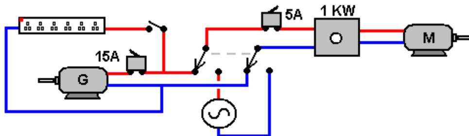
In der gezeigten Stellung ist Fütterung der Generatorstrom zum Antriebsmotor "M". Der 15-Ampere-Sicherung schützt den Generator "G" von einem Kurzschluss irgendwo sonst in der Schaltung. Das 5-Ampere-Sicherung schützt den 1-Kilowatt-Dimmerschalter und der Motor "M". Mit dem Schalter in der anderen Position der Netz (oder der Ausgang von einem batteriegespeisten Inverter) wird dem Motor zugeführt wird, durch, wenn das System gestartet wird.
