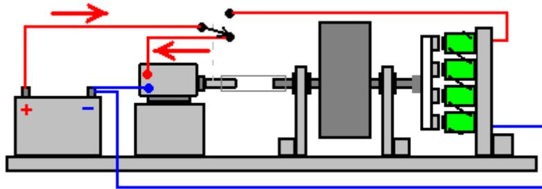
Der Gleichstrommotor Leistung in drei kurze Impulse pro Umdrehung der Motorwelle vorgesehen, wobei die Umschaltung durch Kontakte auf der Motorwelle durchgeführt wird. Das Timing der Pulse ist wie folgt:
