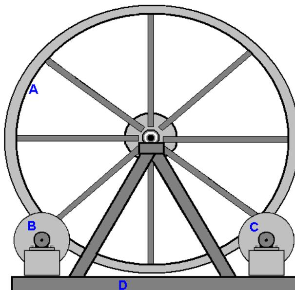
Hier wird das große Schwungrad "A" ist auf einem dreieckigen Rahmen "D" unterstützt und kleinere Schwungräder "C" und möglicherweise "B" geben dem großen Schwungrad einen kurzen Druck auf den Weg zweimal pro Umdrehung. Die Zieldrehzahl für das große Schwungrad ist nur einer Umdrehung pro Sekunde, so dass dies nicht eine einschüchternde Generator-Design und es ist auch in der baulichen Fähigkeit der meisten Menschen.
