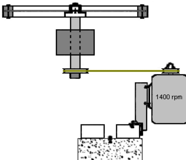
Der Motor dreht sich um 1400 U / min und wird mit zwei Riemenscheiben ausgerüstet, so dass sich sein kleiner Antriebszylinder bei etwa 700 U / min dreht. Der Durchmesser des Antriebszylinders muss so gewählt werden, dass sich das Hauptschwungrad bei 60 U / min dreht und das vom Durchmesser des Hauptschwungrades abhängt, das 2,0 m, 2,5 m oder ein anderer Durchmesser sein kann, der Ihren Bedürfnissen entspricht.
