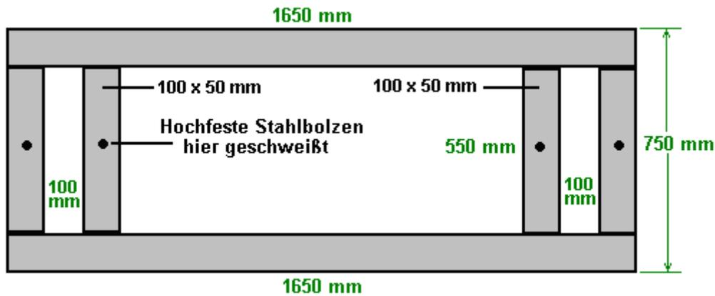
Auch ein starker Gewindebolzen ist in der Mitte eines jeden der Querstücke verschweißt. Ein Stollen ist effektiv ein Gewindebolzen ohne Kopf, und wo der Kopf zu den Basiselementen hätte verschweißt ist, wie oben gezeigt. Diese Bolzen sind wie diejenigen verwendet, um Autoräder befestigen und in dieser Anwendung sind sie etwas, damit der Basis verschraubt werden.
