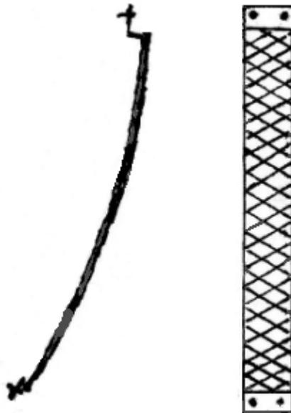
Dieser Streifen ist mit nur einem Punkt am Rand des Hauptschwungrades verschraubt oder verschweißt:
