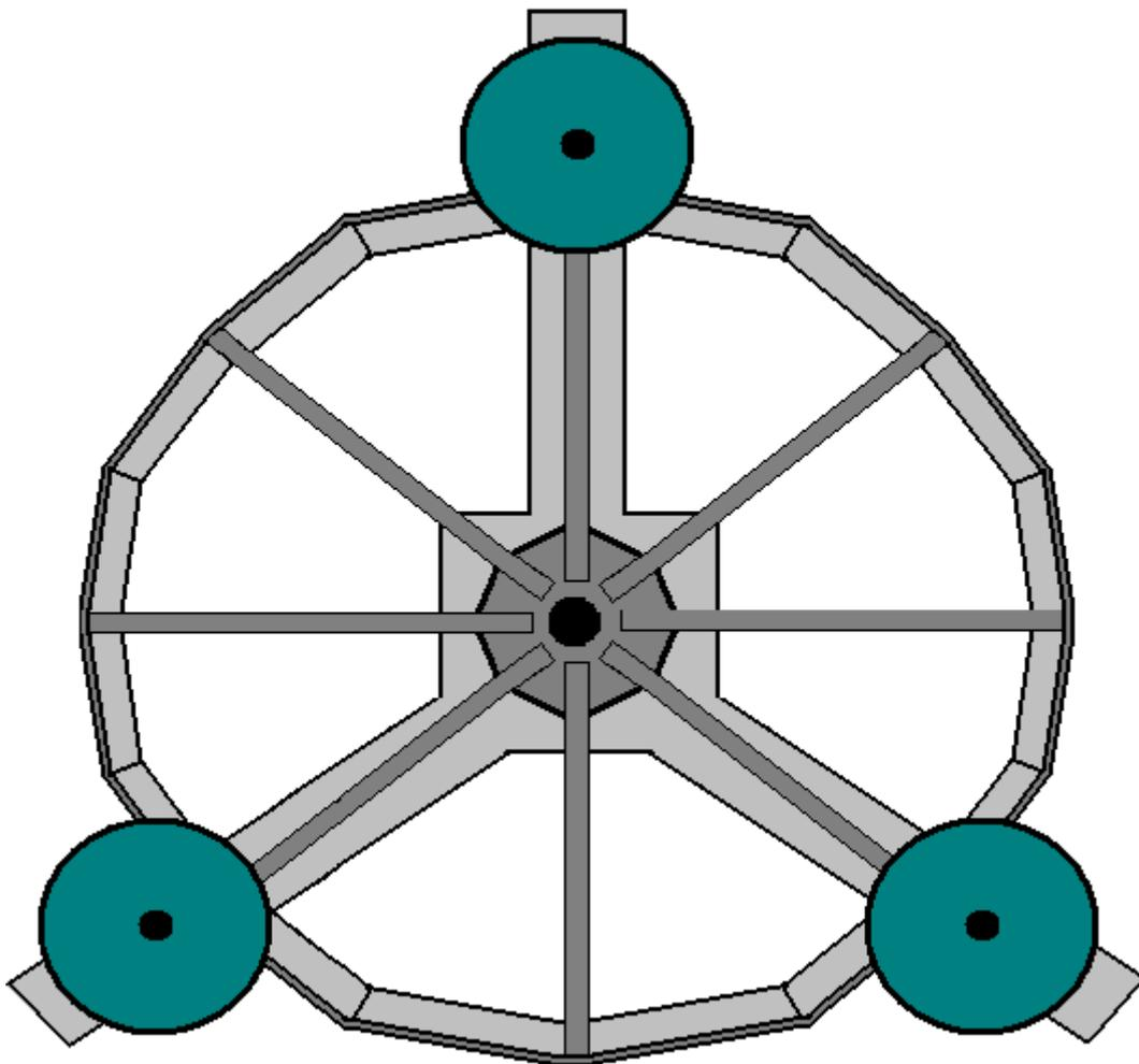
Die zentrale Welle ist mit der Mitte des Betonstützkissens verschraubt und hat ein 16-Zoll-Riemenscheibenrad, das daran befestigt ist:
