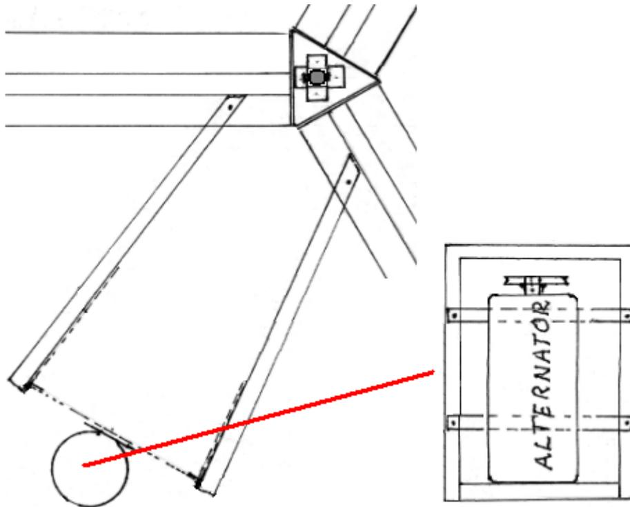
Und der Stahlrahmen ist senkrecht montiert und auf Winkelleisen befestigt, die an den Stahlkastenabschnitten auf dem Betonsockel befestigt sind. Bei sicherer Lagerung werden vertikale Winkelleisen von den beiden Basiselementen aufgestellt, um die Montage von zwei zusätzlichen Drehzapfen für die drei Antriebsriemen zu ermöglichen, die das Hochlaufgetriebe zum Antreiben des Generators bei knapp über 3000 U / min liefern:
