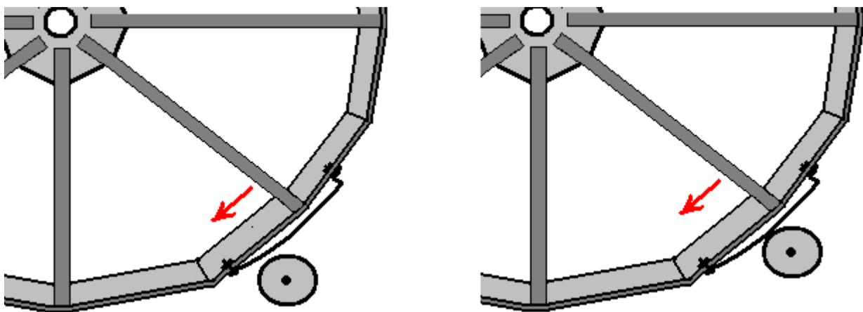
Durch die Positionierung der drei kleinen Schwungräder gibt diese Anordnung dem Hauptschwungrad drei Antriebsimpulse pro Umdrehung, aber jedes der kleinen Schwungräder liefert nur einen Antriebsimpuls pro Umdrehung, und jeder der Antriebsimpulse ist nur von sehr kurzer Dauer:
