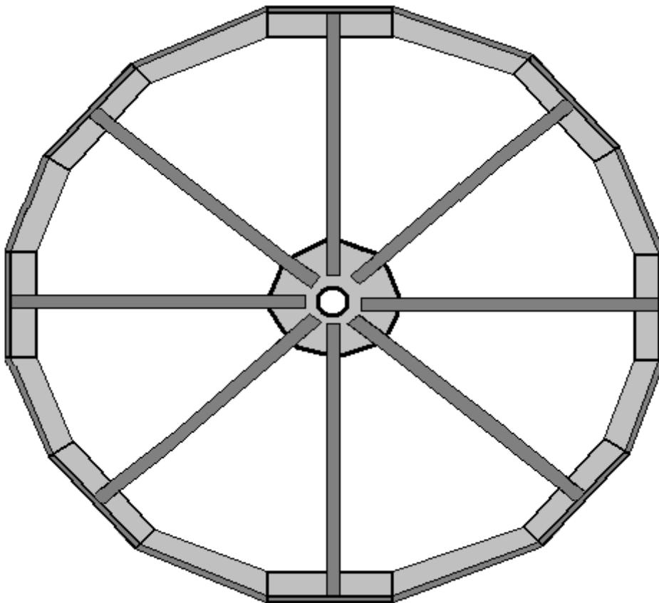
Für diese Konstruktion hat jede der acht Speichen einen rechteckSchnittLänge von 100 x 100 x 8 mm Winkeleisen mit dieser verschweißt. Der Winkeleisen , die etwa 12.276 kg pro Meter wiegt wird wie folgt geformt:
