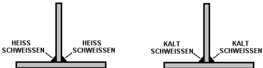
Dann wird, wie die Schweißnähte abkühlen, ziehen sie in entgegengesetzte Richtungen und während es Spannungen im Metall erzeugt, bleibt das vertikale Stück vertikal. Lassen Sie die Schweißnähte in ihre eigenen guten Zeit abkühlen, vielleicht zehn Minuten, um richtig zu kühlen. **Kein** Wasser auf die Schweißnähte gelten die Abkühlung zu beschleunigen, als dass tatsächlich die Struktur des Stahls verändert und Sie wirklich nicht wollen, das zu tun.
