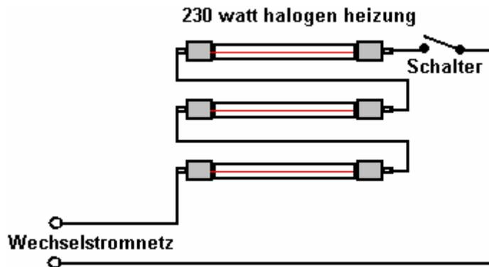
Diese Anordnung 'unter-läuft "die Lampen als jede Lampe wird nur ein Drittel der Spannung, für die es entworfen wurde. Dies hat den Effekt der Erhöhung der Lebensdauer der Lampe erheblich. Sie würden erwarten, dass die Heizleistung sehr schlecht sein, und vielleicht ist es. Aber es den Eindruck, als sehr effektiv und mit allen drei Abschnitten arbeiten gibt, bietet es eine sanfte Wärme und Licht, das sehr effektiv im Sinne einer Raum warm scheint.
