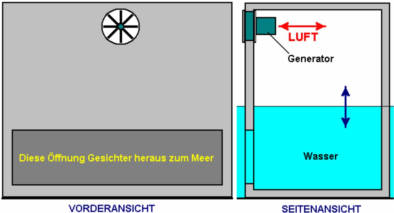
Hier ermöglicht eine große Öffnung das Meer in der Struktur, die den Wasserstand in der Box oben und unten bewegen mit der Wellenbewegung außen macht fließen. Als eine Welle vorbeiläuft, komprimiert er die Luft innerhalb des Kastens und die Luft wird durch den Generator Öffnung angetrieben wird, Drehen der Generator Klingen in der gleichen Weise wie ein Windenergie-Generatoranlage hat seinen Schaufeln durch den Wind gedreht.
