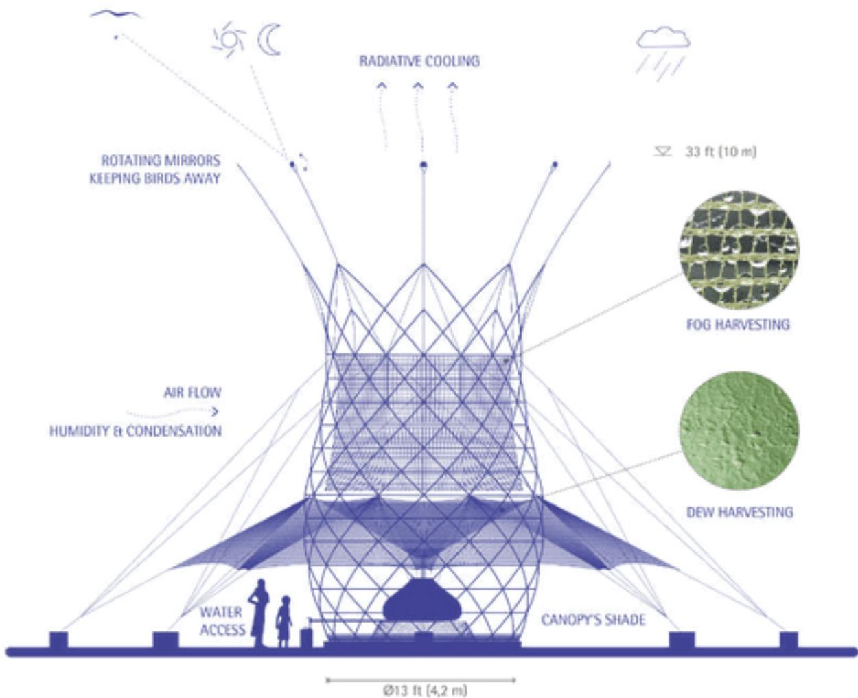
Geliefert als Bausatz mit Bauteilen aus Bambus, ist dieses Gerät 4 Meter breit und 9 Meter hoch mit rotierenden Spiegeln, um Vögel zu verscheuchen. Mit passiver Wassersammel von Nebel, regen und Tau, in Äthiopien getestet kann zwischen 50 und 100 Liter pro Tag zu produzieren. Die Kondensation Material Kunststoffnetz.
