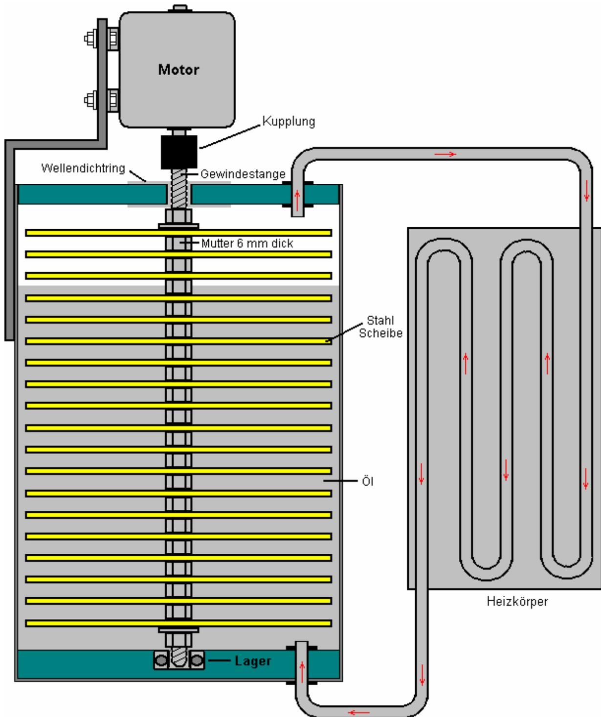
Die zentrale Stange gedreht werden kann durch jeden geeigneten Motor, herkömmlichen, Adams Typs, Puls-Motor, Permanentmagnetmotor oder was auch immer. Eine Alternative zu dieser Art von Betrieb ist, um den rotierenden Motor zu verwenden, um einen Ring von Permanentmagneten nahe neben einer dicken Aluminiumplatte positioniert spinnen. Die Wirbelströme verursachen sehr starken Erhitzung der Aluminiumplatte, die dann Luft eingeblasen, um über ihn die Raumheizung liefern kann.
