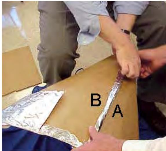
Der einfachste Weg dies zu tun ist, um drei Löcher in den Karton stanzen, dass Line-Up auf Seite A und Seite B (siehe Abbildung). Dann eine Metall brad durch jedes Loch und durch Auseinanderziehen der Metallzinken befestigen. Oder Sie können eine Mutter-und-Bolzen, die beiden Seiten (A & B) miteinander zu verbinden.
