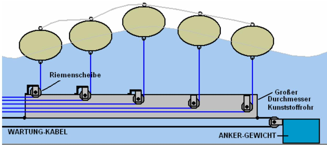
Die Bojen sind auch lose auf der Oberseite mit einer Sicherungsschnur verbunden, so dass sie in einer kompakten Gruppe immer bleiben, obwohl es kaum eine Chance, jede große Seitwärtsbewegung wie die Spannung in der Boje-Kabel ist hoch. Stefan fordert, dass jeder, der seinen Entwurf baut eine Spende via <http://www.o2gruppen.se/> obwohl, wie das geschehen ist macht, ist keineswegs klar für mich, da es nicht angezeigt wird, ein "Donate"-Button auf dieser Website.
