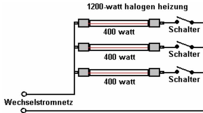
Ich habe die Verbindungen innerhalb meiner insbesondere Heizung, so dass alle drei Halogenlampen in einer Kette verbunden sind. Diese waren nicht mit Schneiden keine Drähte oder irgendwelche neue Verbindungen wie die Drähte, die zu den Lampen push-on 'Spaten' Steckverbinder müssen sowohl für einfache Fertigung und einfachen Austausch einer Halogenlampe zu ermöglichen. Die neue Anordnung ist wie folgt:
