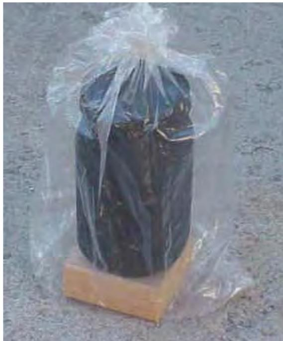
Setzen Sie den Solar-Funnel Herd in der Sonne auf die Sonne zeigt, so dass es so viel Sonnenlicht wie möglich erfasst. Das Design des Trichters ermöglicht es, Solarenergie für etwa eine Stunde, ohne neu positioniert werden sammeln. Bei längeren Garzeiten, stellen Sie die Position des Trichters dem Lauf der Sonne folgen.
