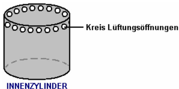
Eine dritte Trommel, die nur geringfügig kleiner als die äußere Trommel ist, wird durch eine Kappe für den inneren Zylinder zu schneiden. Diese Kappe ist nicht eng anliegenden, aber es wirksam verschließt das obere Ende des Spalts zwischen den Seiten des inneren Zylinders und den Seiten der Außentrommel:
