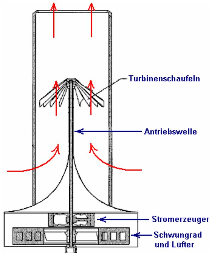
Eine geschickte gemeinsames Merkmal dieser beiden Konstruktionen ist die Verwendung einer stationären kreisförmigen Gehäuse mit Deflektoren, die die Windströmung nutzt keine Rolle, was die Windrichtung zu einem gegebenen Zeitpunkt werden passiert. Blickt man von oben sieht das Gehäuse wie dieses:
