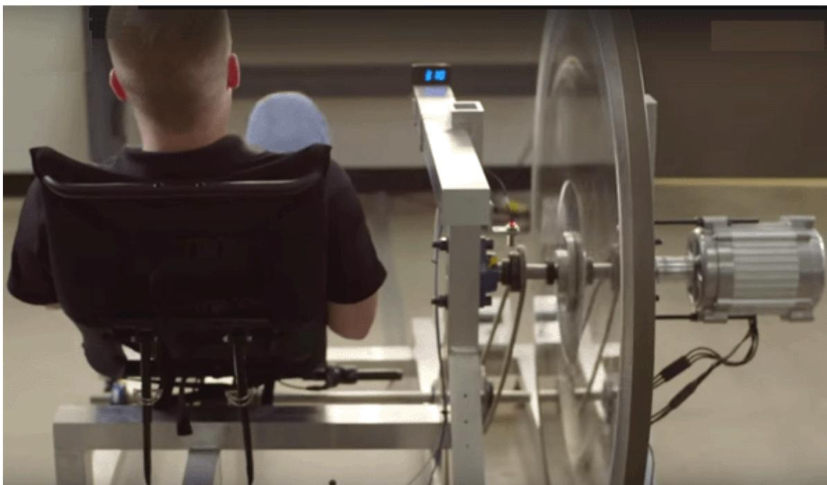
die Radfahrer Pedale in einer Liegeposition und der Belting treibt das Getriebe, die die Generatorwelle dreht:
