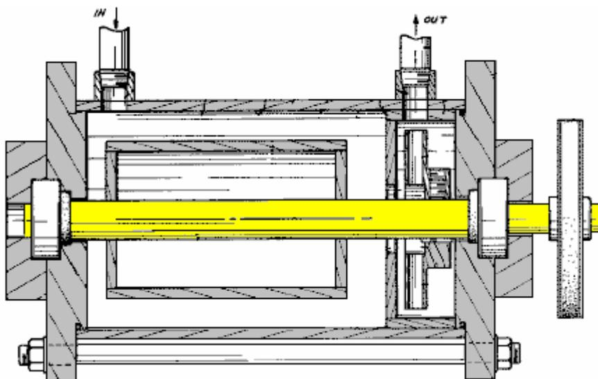
Dies erfordert einen viel größeren Genauigkeit der Konstruktion, dass die Flüssigkeit enthalten muss, obwohl es eine rotierende Welle, die durch das Gehäuse aufweist. Dieses Gerät pumpt die erwärmte Flüssigkeit durch Zentralheizung Rohrleitungen und Heizkörpern.
