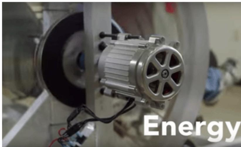
Dies ist der Generator, der durch den Riemen versponnen wird von den Pedalen Getriebe. Das Rad mit dem großen Rand bildet ein Schwungrad und obwohl er es nicht erwähnt, das Schwungrad bewirkt einen Energiegewinn. Der Grundaufbau sieht wie folgt aus:
