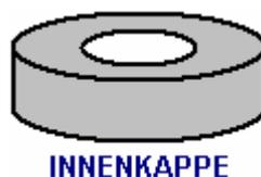
Diese Kappe weist ein kreisförmiges Loch geschnitten darin, und dieses Loch ist nur geringfügig kleiner als der Durchmesser des inneren Zylinders. Es wird durch die Oberlippe der Innentrommel abgestützt aber das Loch groß genug ist, dass sie nicht behindern den Fluss von Wärme durch die Oberseite der inneren Trommel. Diese drei Teile zusammen passen wie diese:
