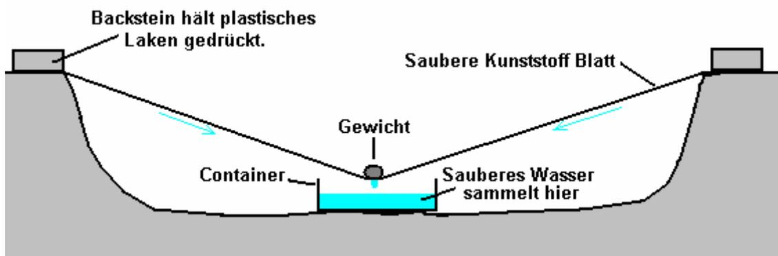
Die Fläche unter der Kunststoffolie wird durch den Treibhauseffekt erhitzt wird. Feuchtigkeit kommt auch von der Erde innerhalb des geschlossenen Loch. Die Feuchtigkeit in der Luft in dem Hohlraum verdichtet auf der Unterseite der Kunststoffbahn. Aber da die Kunststoffolie in einer umgekehrten Pyramide durch das Gewicht oberhalb des Behälters geformt ist, läuft das Wasser ab und tropft in den Behälter. Auch benötigt keine Eingabe Macht und keine beweglichen Teile.
