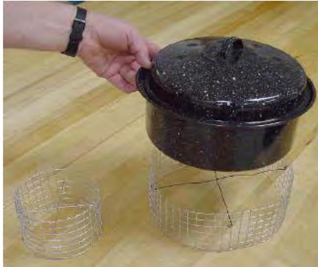
Der dritte Schwerpunkt ist in den Garbehälter verwendet. Die vorliegende Kochgefäß für den Solar-Trichter Cooker ist eine schwarz lackierte Einmachglas. Diese Methode ist auch mühsam und umständlich. Die Einmachgläser kann hart sein, zu reinigen, und sie brechen kann. Design-Änderungen werden getestet, würde damit die Menschen ihre eigenen Kochgeschirr verwenden. Auch dies würde den Herd bequemer zu bedienen.
