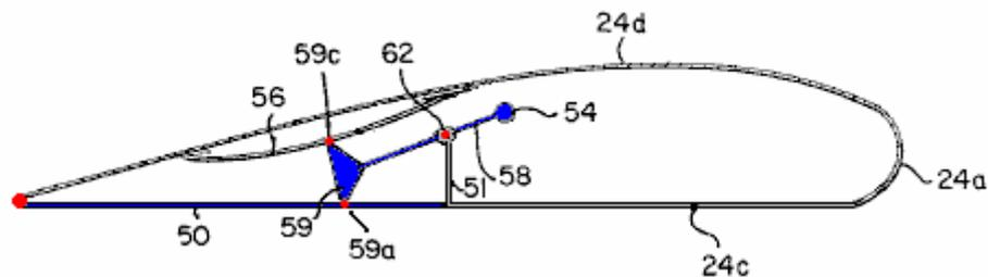
Dies drückt gegen die Feder **56**, zu komprimieren. Das Dreieck Verbindung **59** bewegt sich nach oben, Schwenken an den Punkten **59a** und **59c**, und die Aufnahme-Abschnitt **50** des Flügels. Dadurch ändert sich die Form des Flügels wie hier dargestellt:
