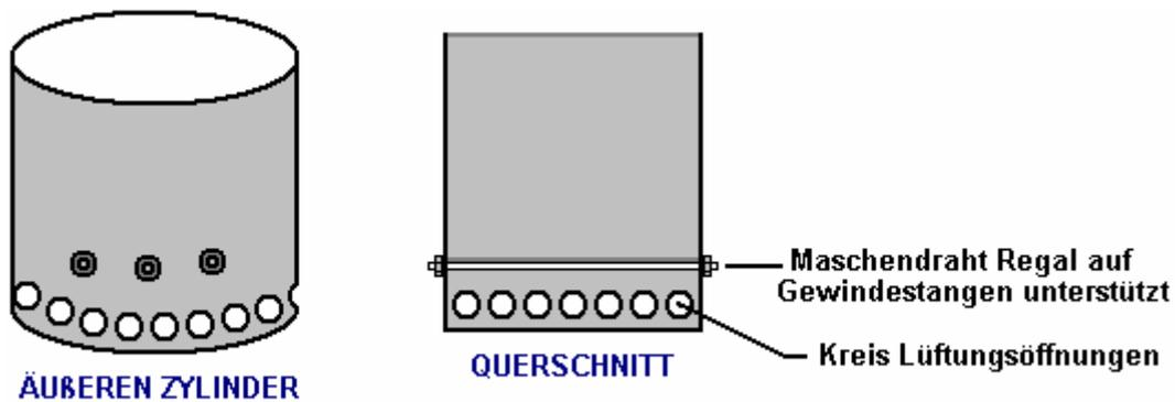
Ein Kreis von Ventilationslöchern ist um den gesamten unteren Rand der Trommel und Gewindestangen gebohrt werden durch die Trommel laufen. Dies unterstützt einen Kreis aus Drahtgeflecht, die einen tragenden Auflage bildet.
