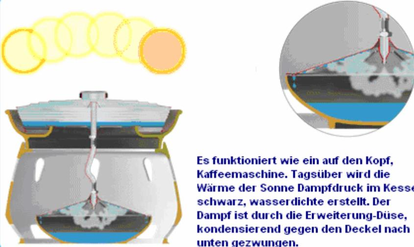
**Es funktioniert wie ein auf den Kopf, Kaffeemaschine. Tagsüber wird die Wärme der Sonne Dampfdruck im Kessel schwarz, wasserdichte erstellt. Der Dampf ist durch die Erweiterung-Düse, kondensierend gegen den Deckel nach unten gezwungen.**
