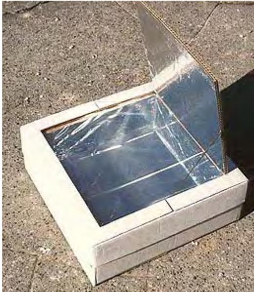
Obwohl Designs für Karton Kochern geworden sind einfach, kann Anbringen eines Deckels immer noch schwierig und zeitaufwendig. In dieser Version ist ein Deckel automatisch von der äußeren Box gebildet.
