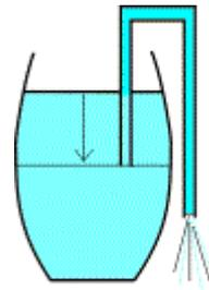
Il meccanismo che rende questo lavoro è chiamato effetto capillare. In altre parole, il peso della colonna di fluido nel tubo con una altezza pari alla differenza in altezza delle due estremità del tubo flessibile fornisce la forza necessaria per mantenere il fluido in movimento. Tuttavia, ciò che sappiamo è che la canna dell'acqua verrà eseguito vuoto se abbiamo appena versate il tutto fuori.
