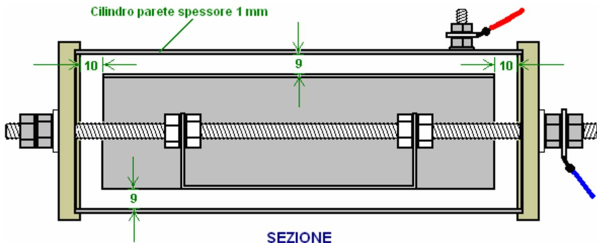
Questo dà un 9 mm tra i due cilindri e questo divario si estende 360 gradi intorno ai cilindri. Il cilindro interno si trova a 10 mm chiaro dei dischi finali Lexan.
