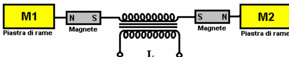
Si afferma che all'accensione del circuito primario, "separazione di cariche" avviene con M1 diventando carica positiva e M2 diventando caricato negativamente e che essi sono "magneticamente polarizzato" quando hanno formato, per la presenza dei magneti. Quando il circuito primario è spento, un "inversione correnti" flussi nel secondario ma i magneti "non esercitano un effetto polarizzante su questa inversione".
