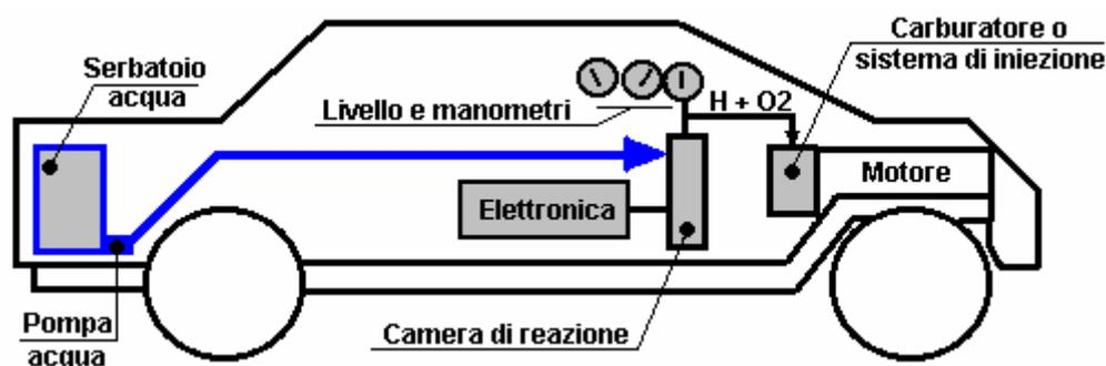
Qui, la macchina ha un serbatoio supplementare installato a contenere una riserva di acqua. Questo è utilizzato per mantenere il livello dell'acqua nella camera di reazione che contiene le piastre elettrodo. Gli elettrodi sono guidati dalla elettronica che applica una forma d'onda impulsiva loro nell'intervallo 0,5-5,0 Amp. La centralina elettronica è alimentato direttamente dalle auto elettrica esistenti. L'idrogeno / ossigeno
