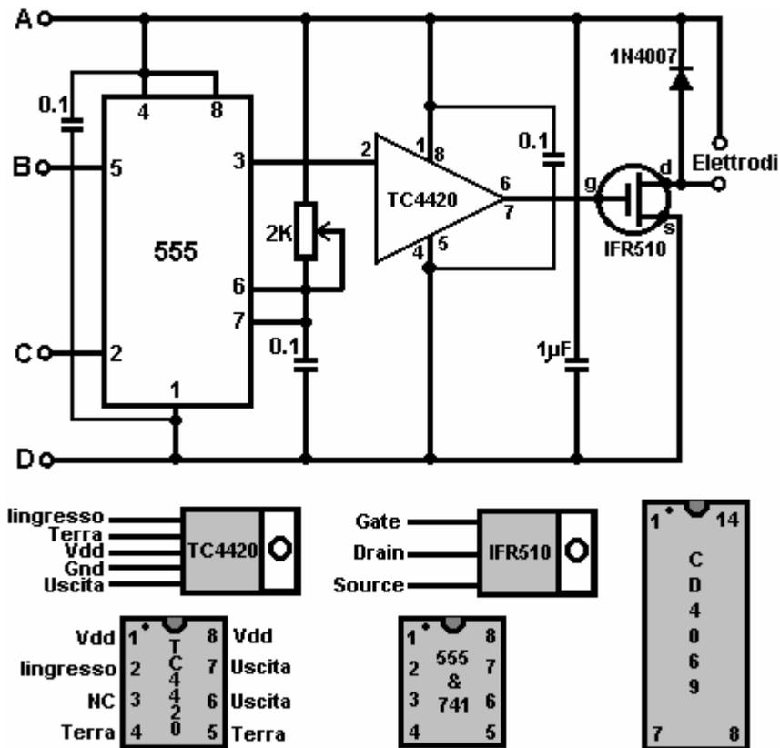
L'uscita del circuito integrato 741 viene regolata tramite la resistenza di 2K variabile, per dare una tensione di uscita (a 'B' punto nello schema elettrico) di 1 Volt quando l'acceleratore macchina sia completamente, e 4 Volt quando la farfalla è completamente giù.
