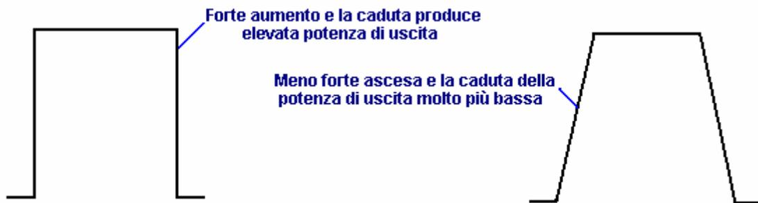
Questa forma d'onda è regolata con attenzione per mantenere il COP fino a 5.4 per motivi di sicurezza. La forma d'onda è anche regolabile in frequenza e Mark / rapporto spaziale.
