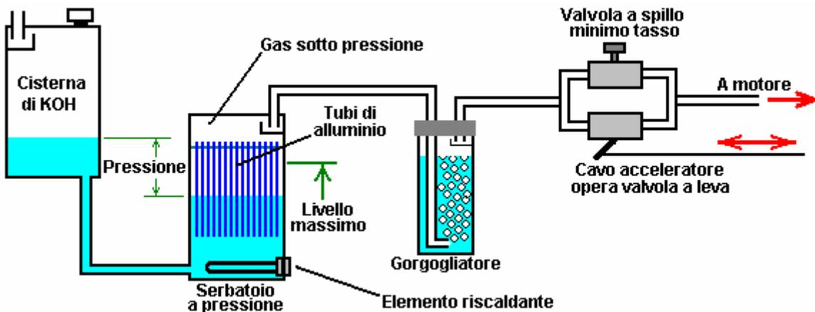
Qui, vi è un serbatoio contenente una miscela 25% di idrossido di potassio (KOH) in acqua. Tale serbatoio è posizionato più in alto rispetto al serbatoio di pressione in cui viene generato il gas idrogeno e il tubo di sfiato è protetta da un setto. Il tubo di sfiato deve fornire una presa per l'aria all'esterno del veicolo o edificio che contiene il sistema.
