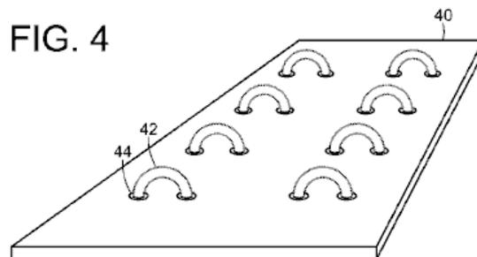
**Fig.4** zeigt eine typische Mittelschicht **40** mit Öffnungen **44**, durch die ein Widerstandsdraht **42** gewickelt wurde. Diese Widerstandsdraht **42** ist mit der Spannungsquelle **33**. Die ersten und zweiten Isolierschichten **46** und **48** aus einem Material, wie Glimmer-Schichten verbunden sind, zu umschließen die zentrale Schicht **40**, um eine elektrische Isolierung von den benachbarten Brennstoffabschnitte **36** und **38** bereitzustellen.
