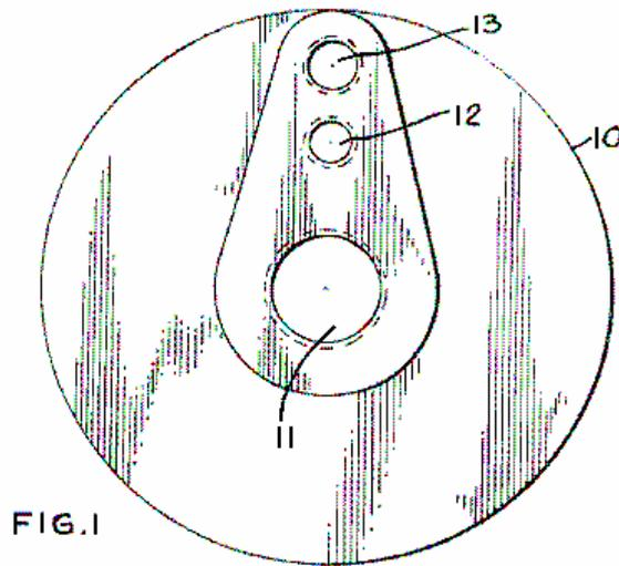
Unter Bezugnahme auf **Fig.1**, ist es angezeigt eine End-Ansicht des Kompressors, wo **10** ist das Kompressor-Gehäuse, **11** ist flüssiger Einlaß, **12** ist das Gas oder Dampf-Bucht und **13** ist die Steckdose.
