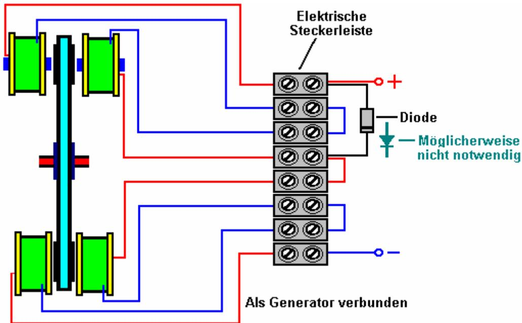
Im Fall des Generators Anordnung besteht die Möglichkeit, zu jedem der vier Paare parallel zu schalten, wie in der Motoranordnung oder um sie in Reihe zu verbinden. Parallel geschaltet sind, können die Spulen aufrechtzuerhalten einen größeren Stromverbrauchsfensters, während, wenn in Reihe geschaltet sind, sie eine höhere Spannung bereitzustellen. Die Spannung könnte durch Erhöhen der Anzahl von Windungen auf jeder Spule erhöht werden.
