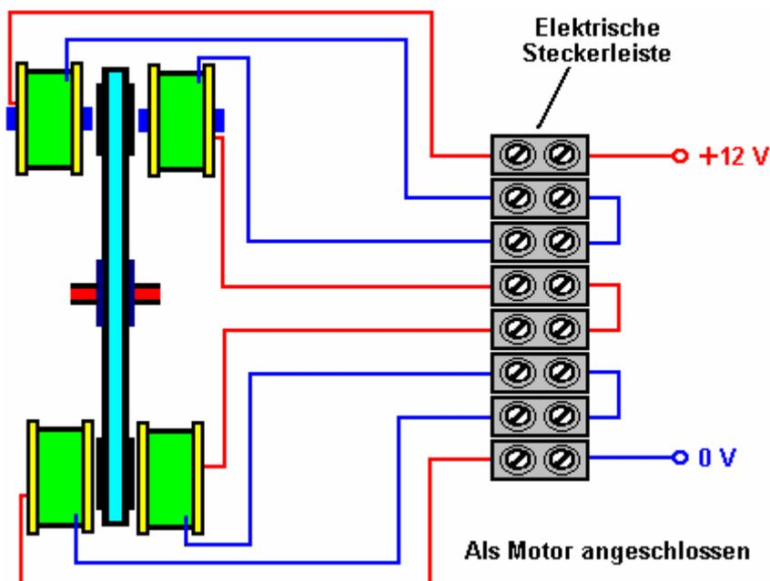
Mit dieser Anordnung für jeden Rotor alle vier Paare Fülldrähte Spulen sind über einander parallel verdrahtet, und alle vier Luft-entkern Spulen sind über einander parallel verdrahtet. Um die Übersichtlichkeit zu verbessern, die obige Abbildung zeigt nur eine der vier Paare, aber in Wirklichkeit gibt es vier Drähte kommen in der linken Seite der einzelnen die Schraubklemmen.
