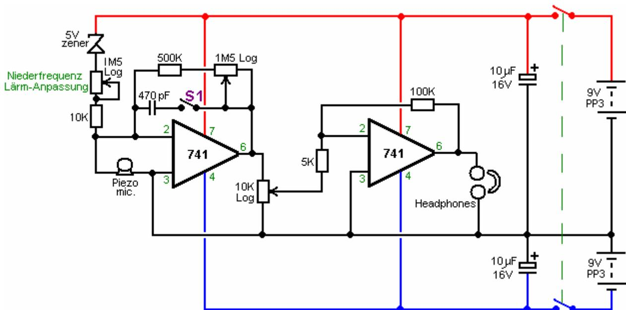
Das weiße Rauschen wird durch den 5-Volt-Zenerdiode erzeugt. Die Höhe dieses weiße Rauschen Komponente wird durch den 1,5 MOhm variablen Widerstand plus die 10K festen Vorwiderstand gesteuert. Während das Spektrum dieser beiden Komponenten ist 10K bis 1,501 Meg. die Arbeitsstellung ist normalerweise sehr hoch, so dass nur eine sehr kleine Menge von weißem Rauschen in den Eingang des ersten op 741 zugeführt. amp. die Mikrophon-Eingang ändern.
