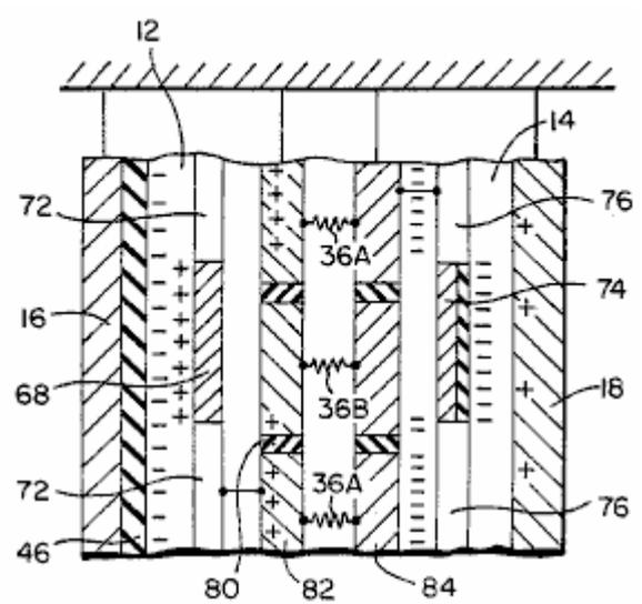
Fig.5A und Fig.5B sind schematische teilweise angelegt Draufsichten der elektrostatischen Generator den Fig.2 bis Fig.4, unter statischen und dynamischen Ladungsverteilung Bedingungen bzw..
