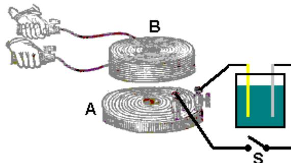
Wenn der Schalter "S" geschlossen wird, die Spulen als ein Luft-Kern-Transformator und der sich rasch verändernde Stromfluss in der Spule "A" induziert eine Spannung in Spule "B". Dass induzierte Spannung hoch wie "B" Kunststoffspule hat viele Kurven und ein erheblicher Schock kann gefühlt werden, wenn die Enden von den Todes gehalten werden, wie oben gezeigt.
