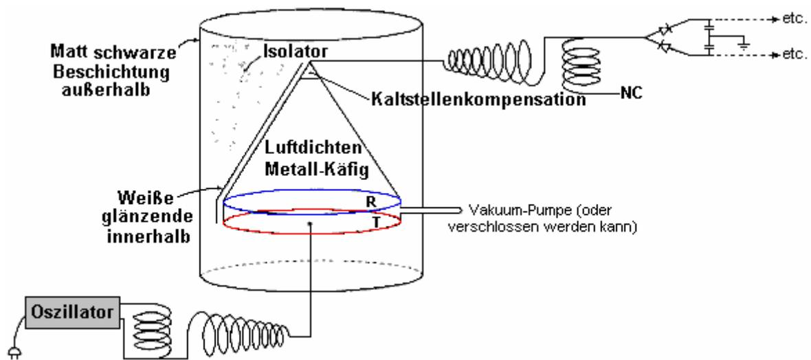
Wo die aktive Aufnahmeplatten **R** und **T** in einem Zylinder eingeschlossen und mit einer Kegelform, das Verfahren zu unterstützen vorgesehen. Die Patentanmeldung enthält eine gute Menge an Informationen und ist lesenswert.
