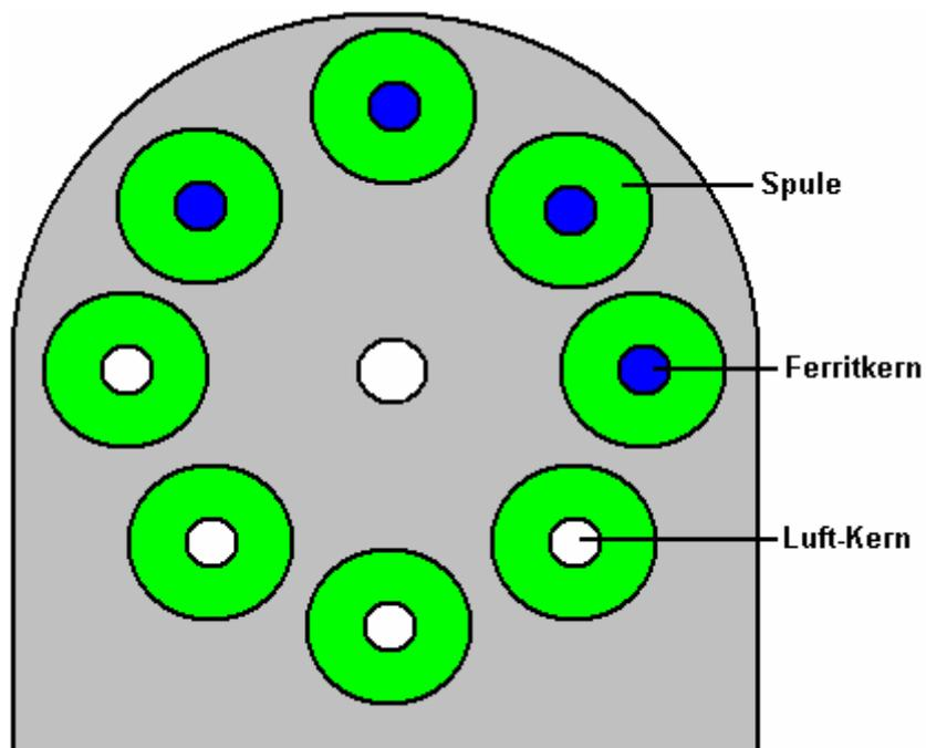
Ferrit ist ein besseres Material für die Kerne der Spulen. Die Statoren gehen beide Seiten der Rotoren und das Loch in der Mitte der Statoren ist, um einen Freiraum für die Welle, auf der die Rotoren montiert sind, geben:
