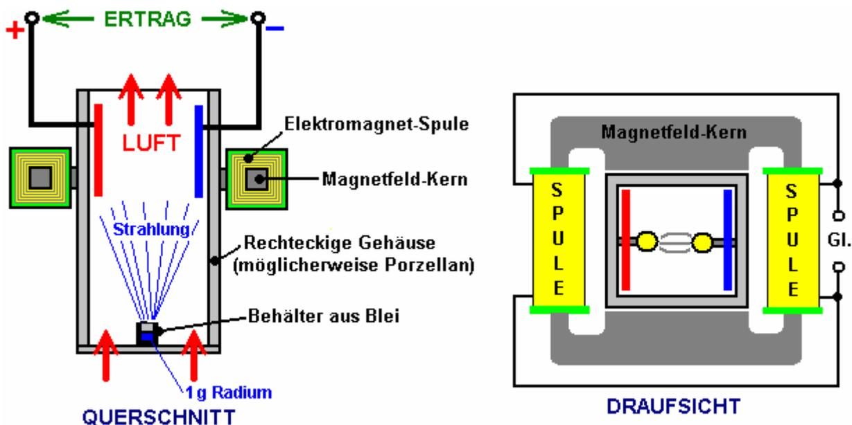
Die Variation der Teslas Gerät oben gezeigt, unterstützt die Führung Behälter mit seiner Gramm Radium auf einem Riemen über dem Boden des Gehäuses. Die Strahlung ionisiert die Luft und das Magnetfeld trennt die Ladungen und leitet sie an gegenüberliegenden Seiten des Gehäuses, um gesammelt und über den Elektrodenplatten eingesetzt werden. Es scheint nicht zu einem Grund sein, warum starke Permanentmagnete dürfen nicht an Stelle der Gleichstrom Elektromagneten eingesetzt werden angezeigt.
