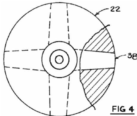
In **Fig.4**, das Laufrad dargestellt, wobei mit **22** das Laufrad **38** und wobei der Fluiddurchgang.
