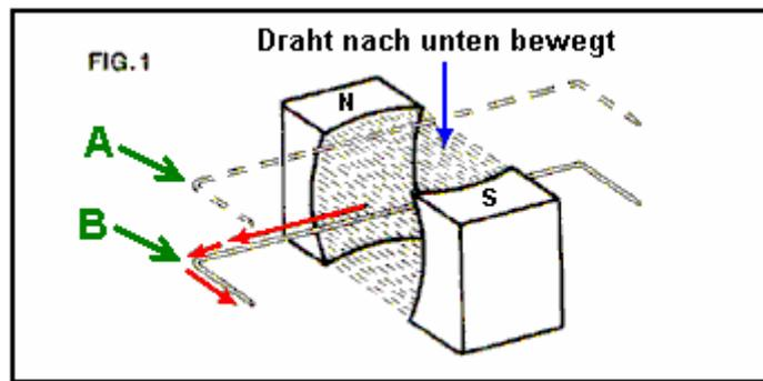
Hier wird eine Drahtschlinge nach unten bewegt wird ab Stufe "A" bis "B". Diese Bewegung bewirkt, dass ein elektrischer Strom nach links entlang des Drahts fließen, wie durch die roten Pfeile dargestellt. Joseph Frage war "warum es in diese Richtung gehen jedes Mal der Draht in dieser Weise bewegt wird?"
